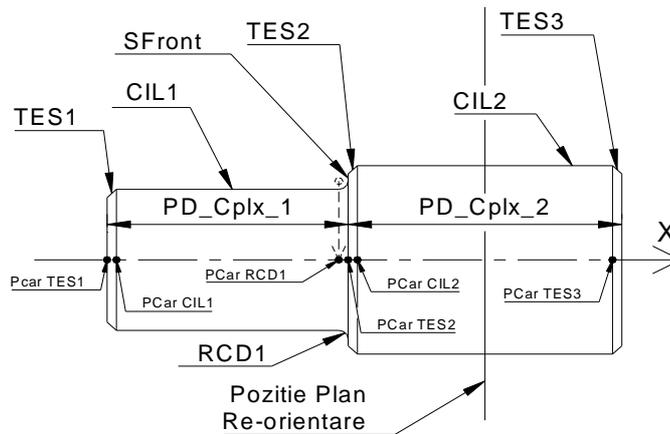
Fig. 6. Simple shaft
