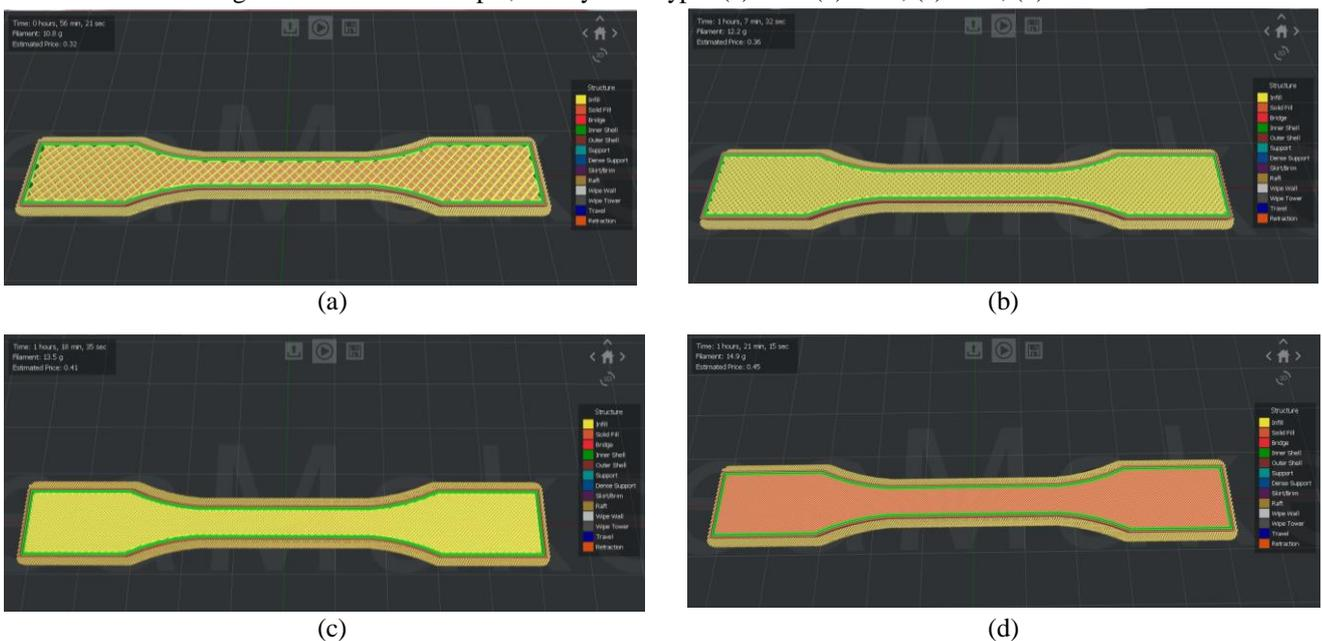
Fig 3. Infill of PLA sample, Rectilinear type:(a) 25% (b) 50%; (c) 75%; (d) 100%
