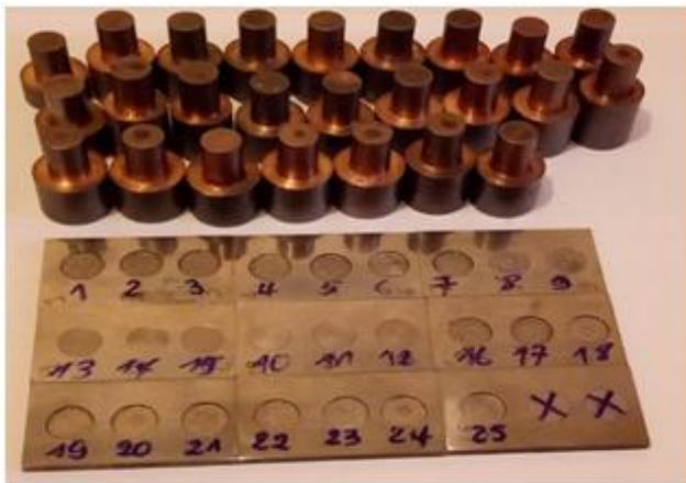
Fig. 2. Works Pieces and Copper-tungsten
