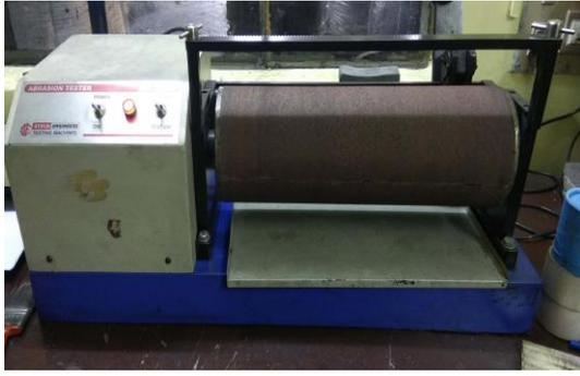
Fig. 4. DIN abrader (DIN 53516)
