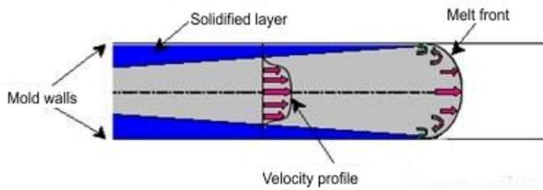
Fig. 10. Polymer melt flow
