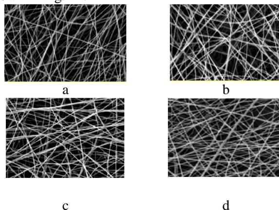
Fig. 14. SEM images of the PEO electrospun nanofibers (a.  $Q=1\text{ml/h}$ ,  $V=10\text{kV}$ ,  $d=4.5\text{ cm}$ ; b.  $Q=1\text{ml/h}$ ,  $V=12\text{kV}$ ,  $d=4.5\text{ cm}$ ; c.  $Q=1\text{ml/h}$ ,  $V=15\text{kV}$ ,  $d=4.5\text{ cm}$ ; d.  $Q=1\text{ml/h}$ ,  $V=10\text{kV}$ ,  $d=120\text{ cm}$ )
