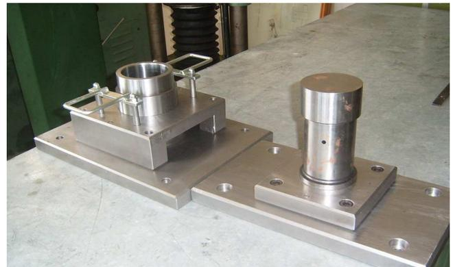
Fig. 6 The ensemble mold and die
