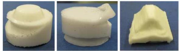
Fig. 16. SR die damaging
